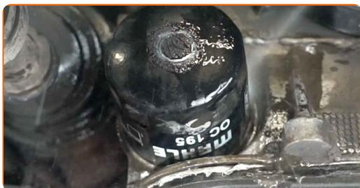
11 Odskrutkujte olejový filter. Použite nástavec 65-14F. Použite ráčňový kľúč.
