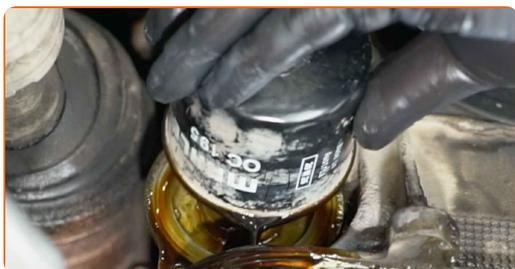
**13** Vyčistite miesto uloženia olejového filtra. Použite viacúčelový čistiaci sprej.
