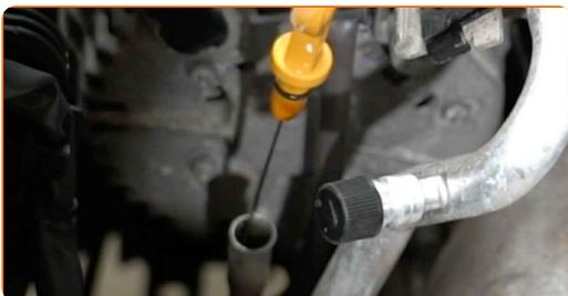
**4** Odskrutkujte zátku plniaceho hrdla olejového systému.
