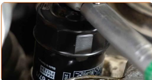
**17** Vyčistite olejový filter. Použite viacúčelový čistiaci sprej.
