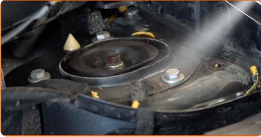
5 Uvoľnite vrchný upevňovací prvok ložiska vzpery tlmiča. Použite nástavec č.13. Použite ráčňový kľúč.
