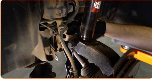
**36** Zaistite stabilizačnú tyč na vzpere zavesenia kolies. Použite imbusový kľúč č. H6. Použite kombinačný kľúč č.17. Použite momentový kľúč. Utiahnite ju krútiacim momentom 44 Nm.
