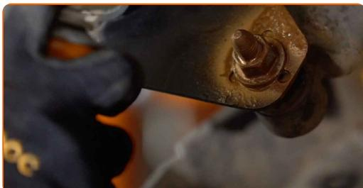
22 Odstráňte upevnenie spod nosníka zadnej nápravy.
