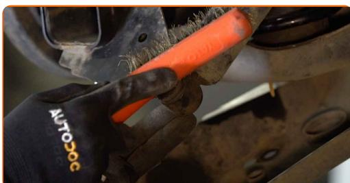
20 Utiahnite spodné upevnenie tlmiča. Použite nástavec č.18. Použite kombinačný kľúč č.18. Použite momentový kľúč. Utiahnite ju krútiacim momentom 105 Nm.
