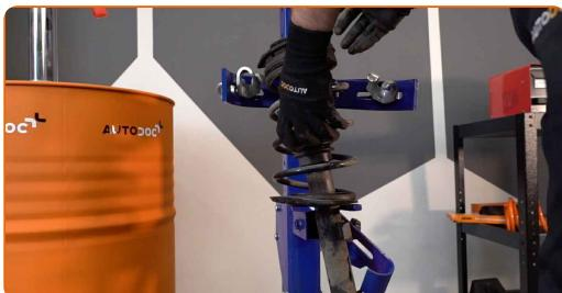
Výmena: pružin podvozku – RENAULT Megane II Hatchback (BM, CM).
