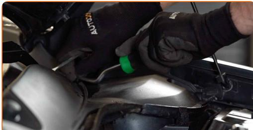
**4** Mierne podvihnite kryt ložiska vzpery tlmiča. Natrite upevnenia ložiska vzpery tlmiča. Použite sprej WD-40.
