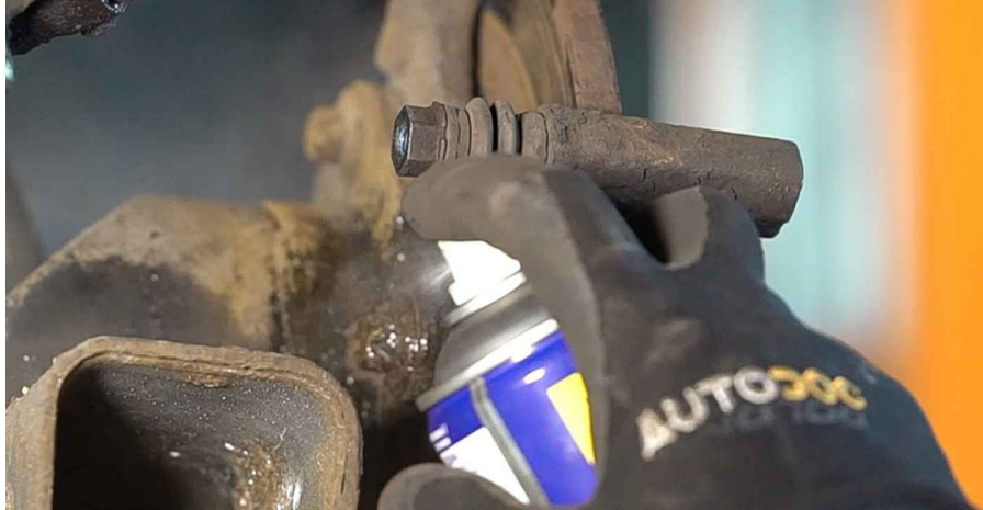
14 Odskrutkujte upevnenie svorky brzdového strmeňa. Použite nástavec č. E16. Použite vratidlo.
