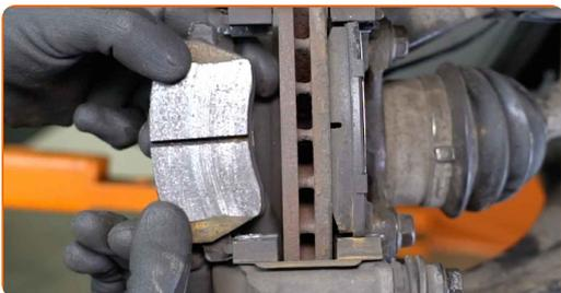
**14** Vyčistite upevňovacie prvky držiaka brzdového strmeňa. Použite drôtenú kefu. Použite sprej WD-40.
