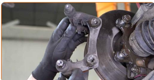
**18** Vyčistite upevňovacie prvky brzdového kotúča. Použite drôtenú kefu. Použite sprej WD-40.
