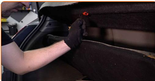
3 Odskrutkujte vrchné upevnenie tlmiča. Použite nástavec č.16. Použite ráčňový klíč.
