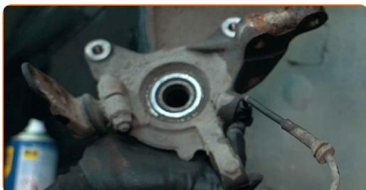
30 Vytlačte náboj z hlavy ložiska čapu kola. Použite sadu vložky a orechu ložiska.
