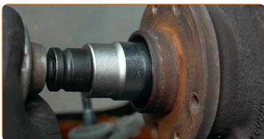
27 Odpojte hnací hriadeľ od hlavy ložiska čapu. Odstráňte upevňovaciú skrutku.
