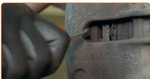
10 Odskrutkujte upevnenie svorky brzdového strmeňa. Použite nástavec č.18. Použite ráčňový kľúč.
