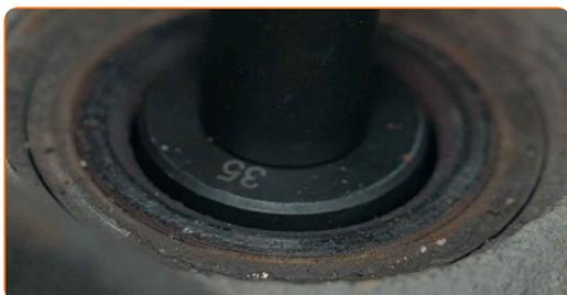
31 Vyčistite zádržný krúžok ložiska náboja kola. Použite drôtenú kefu. Použite sprej WD-40.
