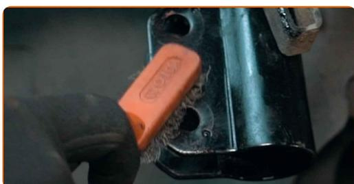
**41** Vyčistite drážky homokinetického kĺbu hnacieho hriadeľa. Použite drôtenú kefu. Použite sprej WD-40.
