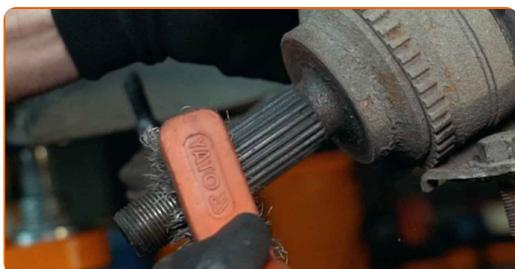
**42** Vyčistite montážnu pozíciu guľového čapu. Použite drôtenú kefu. Použite sprej WD-40.
