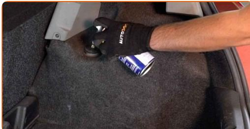
**4** Uvoľnite vrchné upevňovacie prvky tlmiča. Použite nástavec č.17. Použite rozperný nástavec na demontáž tlmičov DDNº6. Použite ráčňový kľúč.
