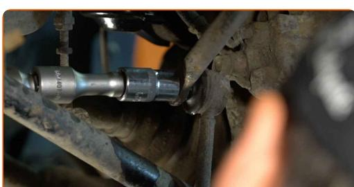
**8** Odskrutkujte upevnenie spájajúce vzperu stabilizátora k vzpere tlmiča. Použite nástavec č.17. Použite ráčňový klúč.
