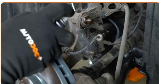
**10.1** Odskrutkujte upevňovacie prvky spájajúce tlmič k hlave ložiska čapu kolesa.
