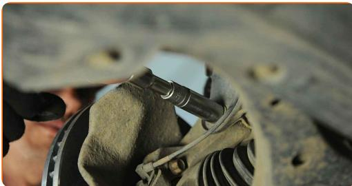
**11** Odpojte vodiče snímača ABS.
