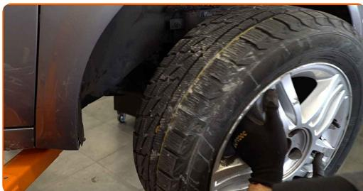
**15** Vyčistite upevňovacie prvky spájajúce vzpery stabilizátora a vzperu tlmiča, a upevňovacie prvky spájajúce vzperu tlmiča a hlavu ložiska čapu. Použite drôtenú kefu. Použite sprej WD-40.
