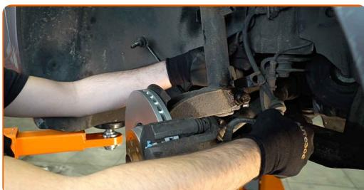
**18** Odskrutkujte spodný upevňovací prvok spájajúci vzperu tlmiča a hlavu ložiska čapu kolesa. Použite nástavec č.18. Použite vratidlo.
