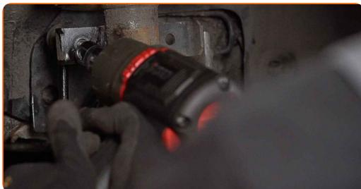
**17** Odpojte vodiče a brzdrovú hadičku od svorky na vzpere tlmiča. Použite páčidlo.
