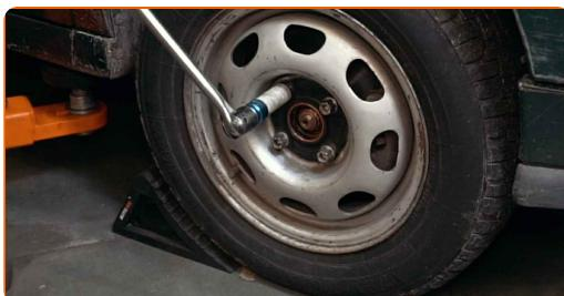
**4** Uvoľnite upevňovací prvok hnacieho hriadeľa. Použite nástavec č.30. Použite vratiidlo.
