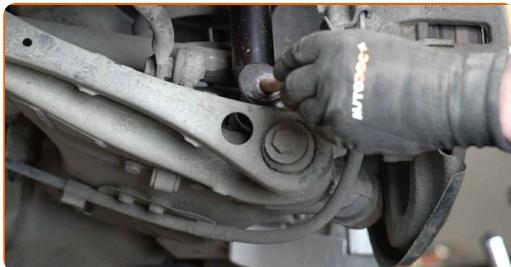
**29** Zaskrutkujte spodné upevnenie tlmiča. Použite kombinačný kľúč č.21. Použite nástavec č.21. Použite ráčňový kľúč.
