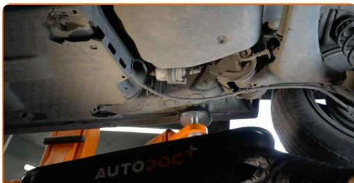
**5** Vyčistite upevňovacie prvky hadičiek na dodávku paliva. Použite nylonovú čistiacu kefu Použite viacúčelový čistiaci sprej.
