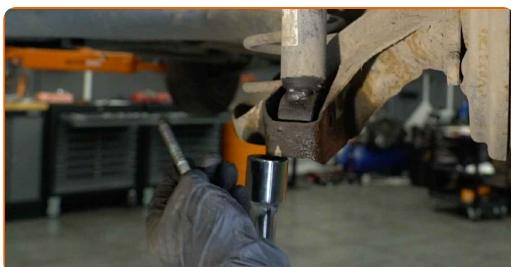
11 Odstráňte upevnenie spod nosníka zadnej nápravy.
