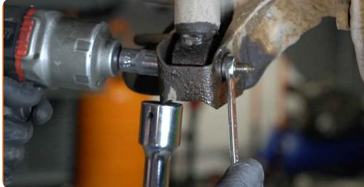
9 Odskrutkujte vrchné upevnenie tlmiča. Použite nástavec č.16. Použite ráčňový kľúč.
