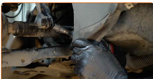
**8** Odskrutkujte upevnenie spájajúce vzperu stabilizátora k vzpere tlmiča. Použite nástavec č.16. Použite ráčňový klíč.
