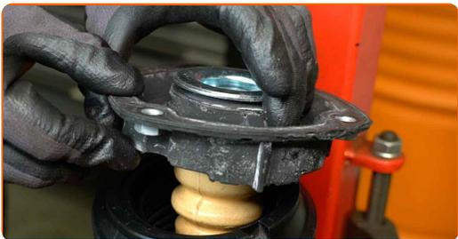
**42** Upevnite maticu piestu vzpery tlmiča. Použite 21-mm kľúč na montáž matice tlmiča. Použite imbusový kľúč č. H7. Použite momentový kľúč. Uťahnite ju krútiacim momentom 60 Nm.
