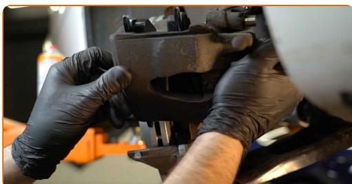
Výmena: brzdových strmenov – SEAT Leon Hatchback (1M1). AUTODOC odporúča:
