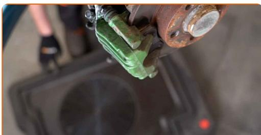
12 Odskrutkujte prvky brzdovej hadičky od brzdového strmeňa. Použite nástavec č.13. Použite ráčňový kľúč.
