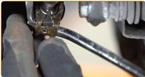
9 Odpojte lanko ručnej brzdy od strmeňa. Použite kliešte na vodnú pumpu. Uvoľnite lanko parkovacej brzdy.
