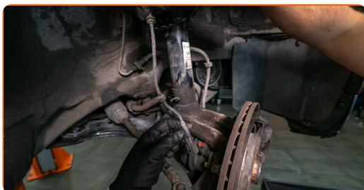
**42** Vyčistite montážny otvor disku kolesa. Použite drôtenú kefu. Natrite kontaktný povrch. Použite medené mazivo.
