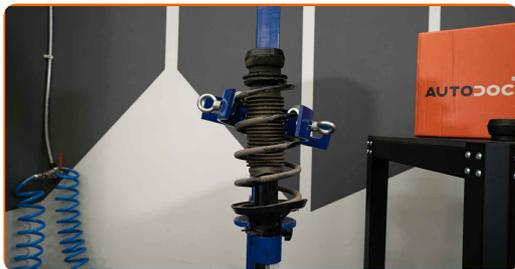
**25** Odstráňte skrutku piestnice vzpery. Použite prerezaný kľúč na palivové potrubie č. 22. Použite imbusový kľúč č. H6.
