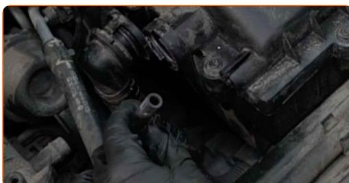
5 Uvoľnite upevňovacie skrutky krytu vzduchového filtra. Použite hviezdicový Torx T25. Použite ráčňový kľúč.
