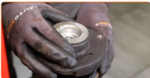
**50** Upevnite maticu piestu vzpery tlmiča. Použite 21-mm kľúč na montáž matice tlmiča. Použite imbusový kľúč č. H6. Použite momentový kľúč. Uťahnite ju krútiacim momentom 60 Nm.
