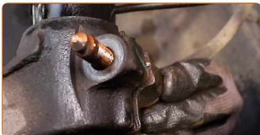
**63** Zaskrutkujte upevňovací prvok, ktorý spája tlmič k hlave ložiska čapu. Použite nástavec č.18. Použite XZN č. 14. Použite ráčňový kľúč.
