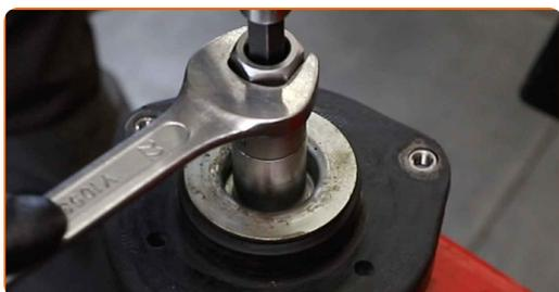
Výmena: jednotka pruženia, tlmič pruženia – SEAT Toledo III (5P2). Tip:
