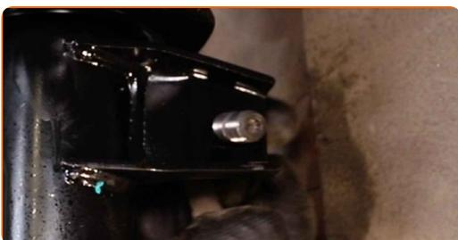
**70** Utiahnite upevňovací prvok vzpery stabilizátora. Použite nástavec č.18. Použite XZN č. 6. Použite ráčňový kľúč.
