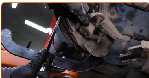
**32** Uvoľnite spodný upevňovací prvok spájajúci vzperu tlmiča a hlavu ložiska čapu kolesa. Použite špeciálny nástavec na odstránenie tlmiča.
