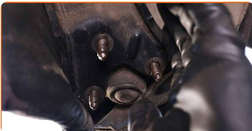
**68** Utiahnite upevňovacie prvky, ktoré spájajú guľový čap k ramenu zavesenia kolies. Použite nástavec č.16. Použite ráčňový kľúč.
