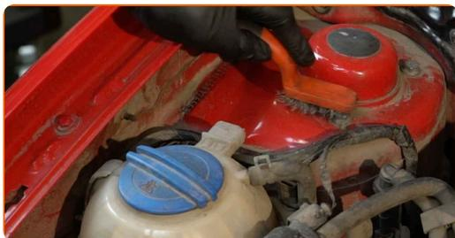
**4** Uvoľnite vrchný upevňovací prvok ložiska vzpery tmiča. Použite nástavec č.13. Použite ráčňový kľúč.
