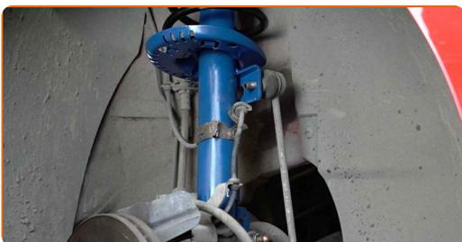
**67** Utiahnite upevnenie spájajúce vzperu stabilizátora k vzpere tlmiča. Použite nástavec č.17. Použite momentový kľúč. Utiahnite ju krútiacim momentom 40 Nm.
