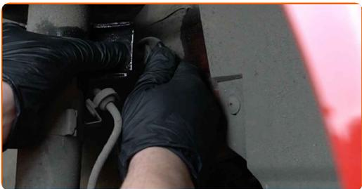
**15** Vyčistite držiak zväzku vodičov ABS. Použite drôtenú kefu. Použite sprej WD-40.
