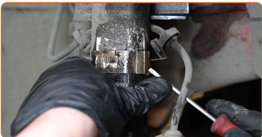
**17** Odpojte brzdovú hadičku. Použite páčidlo.
