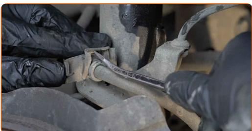
**18** Odpojte vodiče snímača ABS.
