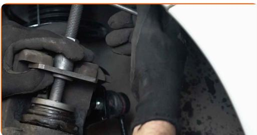
**16** Očistite brzdový strmeň od prachu a špiny. Použite drôtenú kefu.
