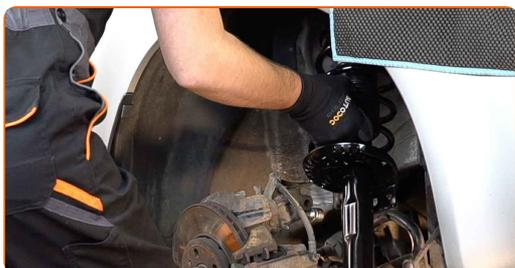
45 Zaskrutkujte vrchné upevnenie uloženia vzpery tlmiča. Neuťahujte ho.
