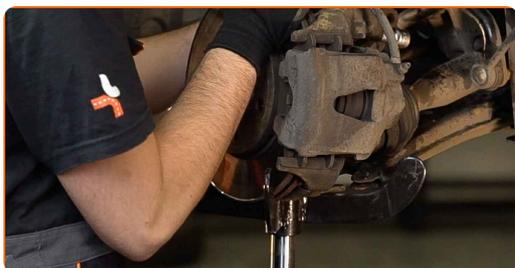
49 Vyčistite drážky homokinetického kĺbu hnacieho hriadeľa. Použite sprej WD-40.
