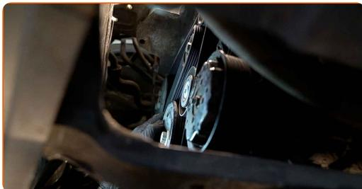
Výmena: ozubeneho klinového remeňa – SKODA Fabia II Hatchback (542). Tip od AUTODOC:
