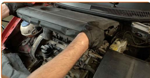
Výmena: vodné čerpadlo + sada ozubeného remeňa – SKODA Fabia II Hatchback (542). Tip:
