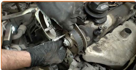
**52** Odskrutkujte upevňovacie prvky bočného krytu rozvodov motora. Použite nástavec č.10. Použite imbusový kľúč č. H6. Použite ráčňový kľúč.
