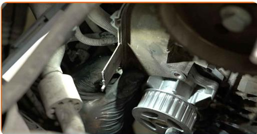
**61** Zaskrutkujte upevňovacie prvky vodnej pumpy. Použite imbusový kľúč č. H6. Použite ráčňový kľúč.
