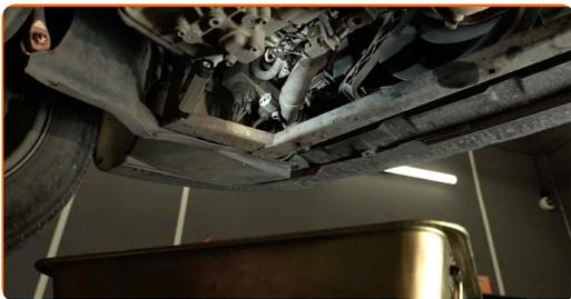
**14** Otvorte výpustný kohútik chladiacej kvapaliny.
