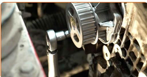
**63** Zaskrutkujte upevňovacie prvky bočného krytu rozvodov motora. Použite nástavec č.10. Použite ráčňový kľúč.
