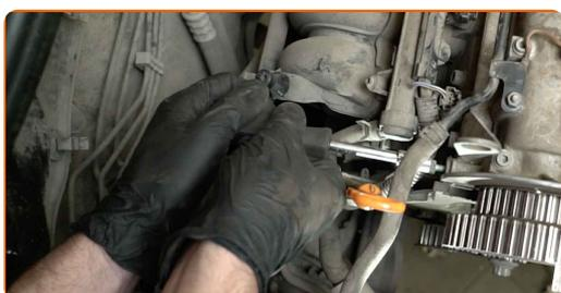
**53** Odstráňte bočný kryt rozvodov motora.
