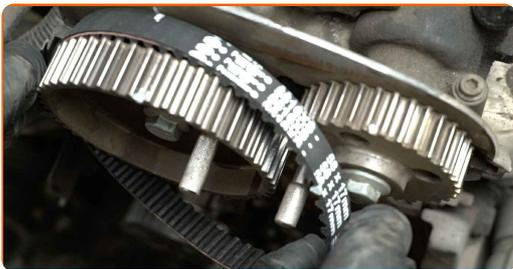
Výmena: vodné čerpadlo + sada ozubeného remeňa – SKODA Fabia II Hatchback (542). Odporúčajú odborníci z AUTODOC:
