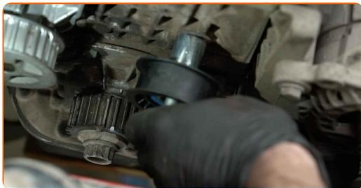
**69** Utiahnite upevňovací prvok vodiacej kladky rozvodového remeňa. Použite nástavec č.15. Použite momentový kľúč. Utiahnite ju krútiacim momentom 25 Nm.
