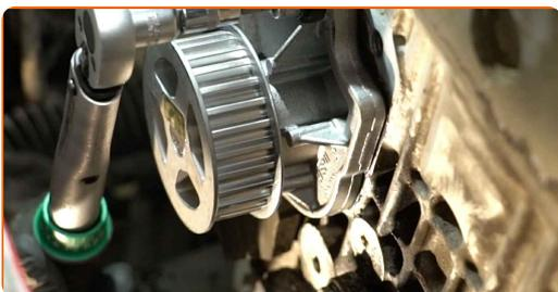
**62** Utiahnite upevňovacie prvky vodnej pumpy. Použite imbusový kľúč č. H6. Použite momentový kľúč. Utiahnite ju krútiacim momentom 20 Nm.
