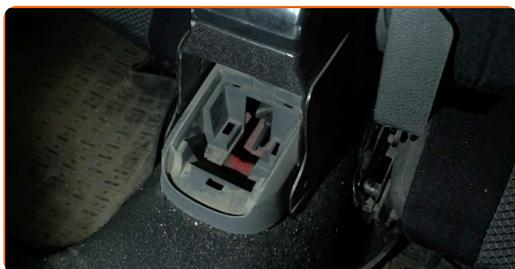
**10** Uvoľnite lanko parkovacej brzdy. Použite kombinačný kľúč č.10.
