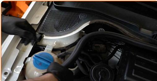
4 Zdvíhnite a odstráňte mriežku na odvádzanie vody.
