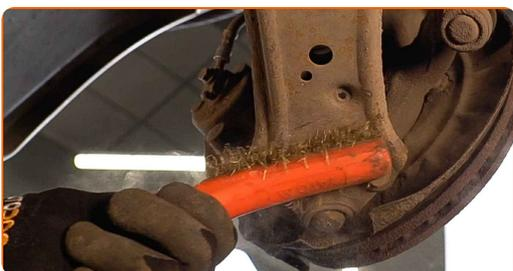
**18** Odskrutkujte upevňovací prvok spájajúci guľový čap a ovládacie rameno odpruženia. Použite nástavec č.13. Použite ráčňový kľúč.
