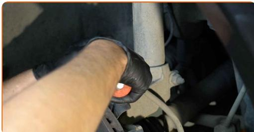
**16** Vyčistite upevňovacie prvky spájajúce vzperu tlmiča a hlavu ložiska čapu kolesa. Použite drôtenú kefu. Použite sprej WD-40.
