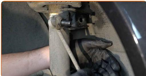
**15** Odpojte vodič a brzdovú hadičku od svorky na vzpere tlmiča. Použite páčidlo.
