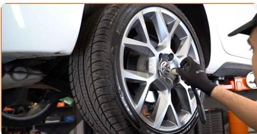
Výmena: ložiska kola – SKODA Octavia III Combi (5E5). Tip:
