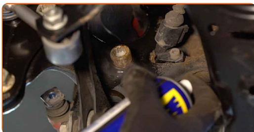
**11** Odskrutkujte upevnenie svorky brzdového strmeňa. Použite XZN č. 12. Použite vratidlo. Použite ráčňový kľúč.
