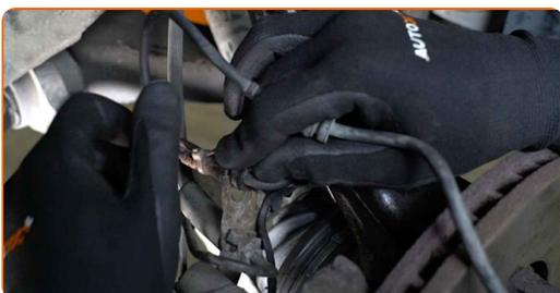
**72** Ošetríte konektor ABS snímača. Použite dielektrické mazivo.
