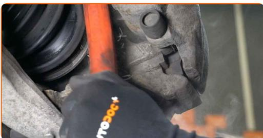
**12** Odskrutkujte upevnenie svorky brzdového strmeňa. Použite nástavec č.17. Použite ráčňový kľúč. Použite vratidlo.
