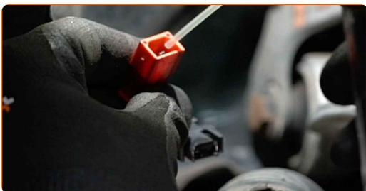
**73** Pripevnite konektor ABS snímača.
