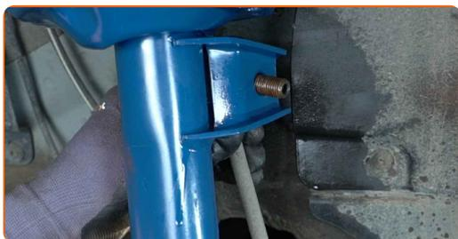
**59** Zaskrutkujte upevnenie spájajúce záves stabilizátora k tlmiču. Použite kombinačný kľúč č.18 Použite XZN č. 6. Použite ráčňový kľúč.
