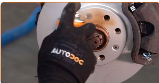
**20** Vyčistite povrch brzdového kotúča. Použite čistič brzd.
