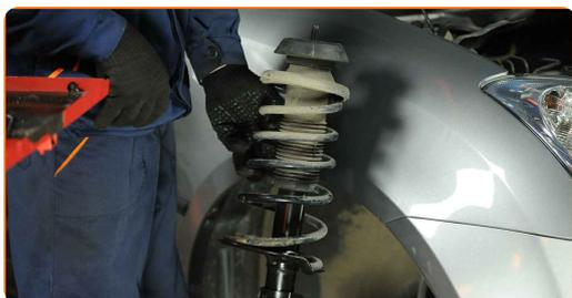
**44** Zaskrutkujte vrchné upevnenie uloženia vzpery tlmiča.
