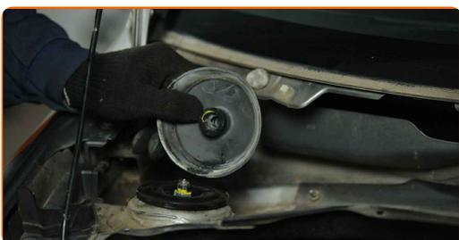
**23** Vyčistite upevňovacie prvky vrchného ložiska vzpery tlmiča. Použite drôtenú kefu. Použite sprej WD-40.
