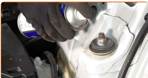
**14** Uvoľnite horný upevňovací prvok tlmiča. Použite imbusový kľúč č. H6. Použite nástavec č.17. Použite ráčňový kľúč.
