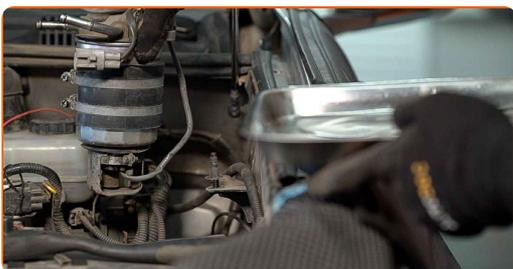
**8** Odskrutkujte držiak snímača vody v palive. Použite nástavec č.8.
