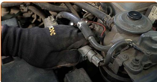
**4** Uvoľnite upevňovacie svorky rúrok palivového filtra. Použite okrúhle kliešte.
