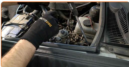
**29** Pripojte konektor snímača vody v palive.
