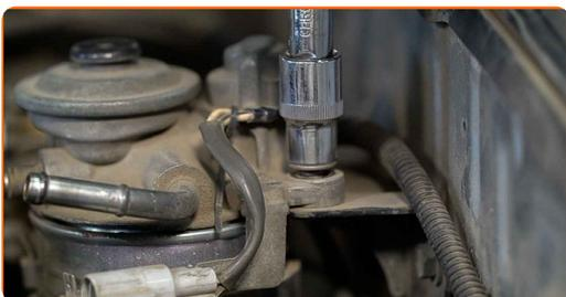
**7** Odstráňte palivový filter. Starú kazetu olejového filtra vložte do nádoby.
