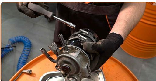
**21** Odstráňte O-kružok snímača vody v palive. Použite plochý skrutkovač.
