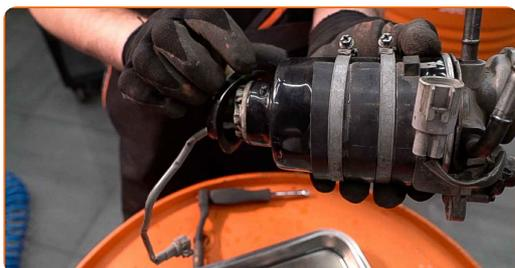
**26** Zaskrutkujte držiak snímača vody v palive. Použite nástavec č.8. Použite ráčňový kľúč.
