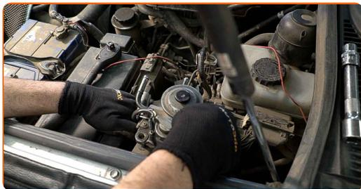
**28** Utiahnite upevňovacie prvky palivového filtra. Použite nástavec č.12. Použite ráčňový kľúč.
