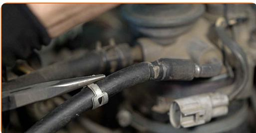
**5** Odpojte rúrky od palivového filtra.
