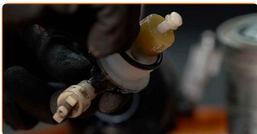
**24** Zaskrutkujte snímač vody v palive.
