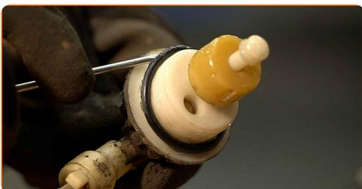
**22** Vyčistite snímač vody v palive. Použite viacúčelový čistiaci sprej.
