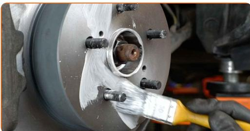
**49** Vyčistíte povrch brzdového kotúča. Použite čistič brzd.
