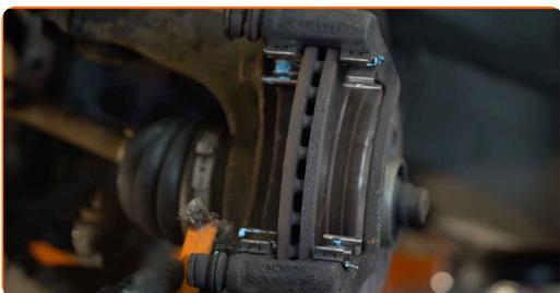
13 Odskrutkujte upevnenie svorky brzdového strmeňa. Použite nástavec č.17. Použite vratidlo. Použite ráčňový kľúč.
