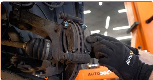
12 Vyčistite upevňovacie prvky držiaka brzdového strmeňa. Použite drôtenú kefu. Použite sprej WD-40.
