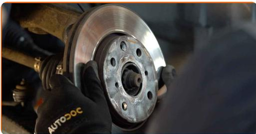
17 Vyčistite náboj. Použite drôtenú kefu. Natrite kontaktný povrch. Použite medené mazivo.
