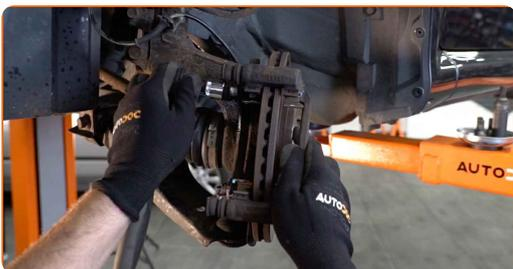
15 Odskrutkujte upevnenie brzdového kotúča. Použite krížový skrutkovač PH.
