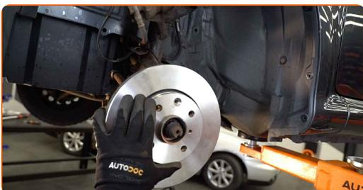
19 Upevnite upevnenie brzdového kotúča. Použite krížový skrutkovač PH. Použite momentový kľúč. Uťahnite ju krútiacim momentom 5 Nm.
