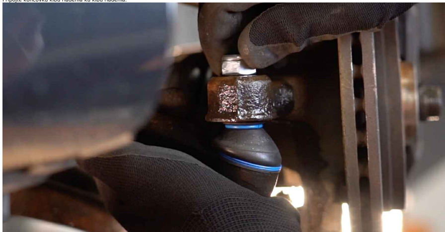
18 Utiiahnite upevňovaciu maticu spájajúcu čap tiahla riadenia k hlave ložiska čapu kolesa. Použite nástavec č.17. Použite momentový kľúč. Utiiahnite ju krútiacim momentom 33 Nm.
