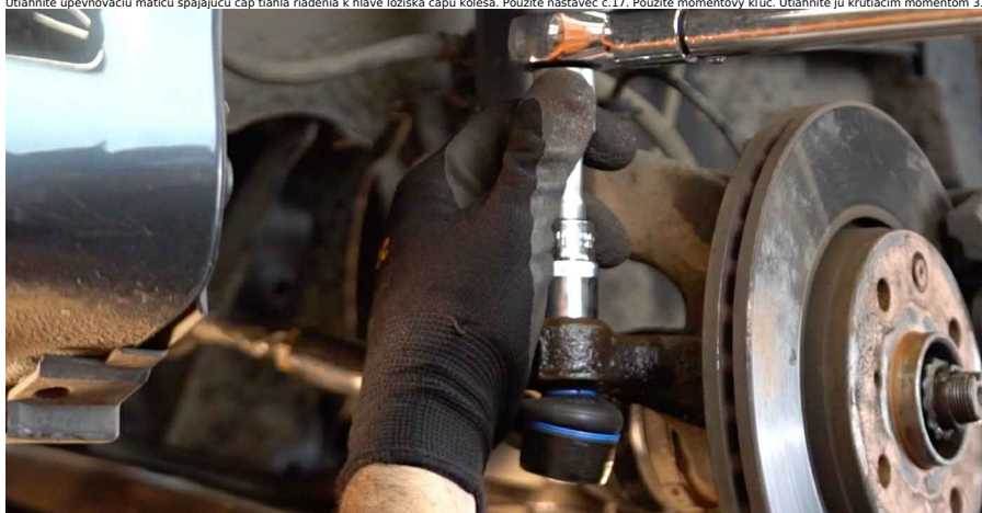
19 Upevnite uzamykaciu skrutku na koncovke tiahla. Použite kombinačný kľúč č.17. Použite kombinačný kľúč č.19. Použite momentový kľúč. Utiiahnite ju krútiacim momentom 47 Nm.
