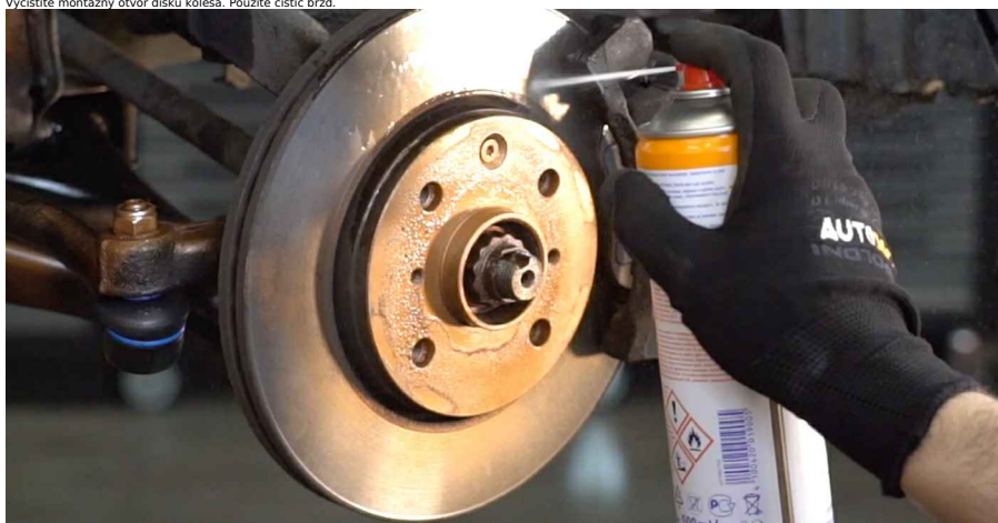
23 Vyčistite montážny otvor disku kolesa. Použite čistič brzd.
