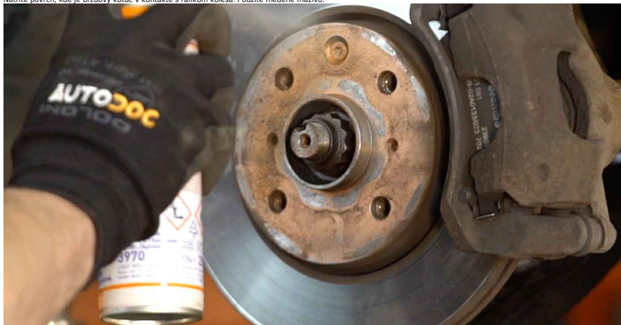
23 Vyčistite montážny otvor disku kolesa. Použite čistič brzd.
