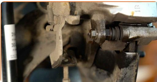
**9** Odskrutkujte upevnenie brzdového strmeňa. Použite kombinačný kľúč č.14. Použite kombinačný kľúč č.17.
