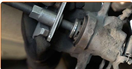
**26** Nainštalujte brzdový strmeň a upevnite ho. Použite kombinačný kľúč č.17. Použite nástavec č.14. Použite momentový kľúč. Utiahnite ju krútiacim momentom 35 Nm.
