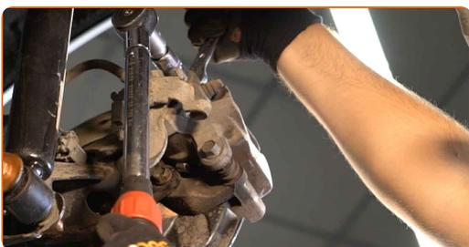
**27** Nainštalujte lanko parkovacej brzdy na držiak brzdového strmeňa.
