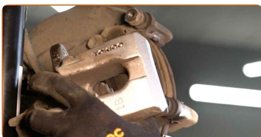
**Výmena: brzdových kotúčov – TOYOTA COROLLA limuzina (E15\_). Tip:**
