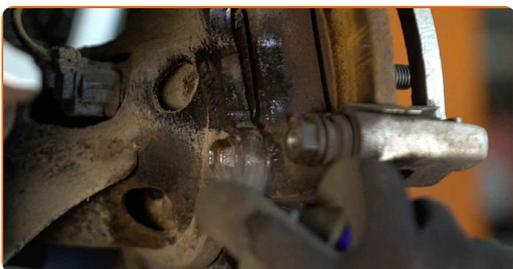
**14** Odskrutkujte upevnenie svorky brzdového strmeňa. Použite nástavec č.14. Použite vratidlo. Použite ráčňový kľúč.
