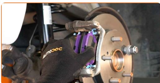
**24** Natrite piest brzdového strmeňa. Použite čistič brzd.
