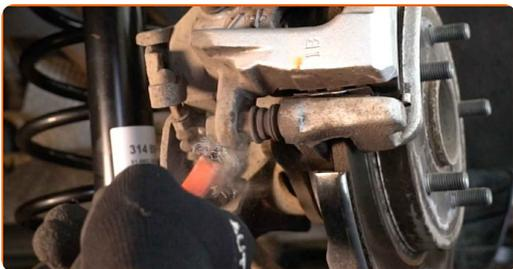
**8** Odpojte lanko parkovacej brzdy od držiaka brzdového strmeňa. Použite kliešte na vodnú pumpu.
