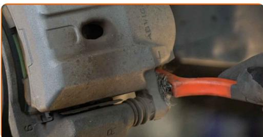
**9** Odskrutkujte upevnenie brzdového strmeňa. Použite kombinačný kľúč č.13. Použite kombinačný kľúč č.17.
