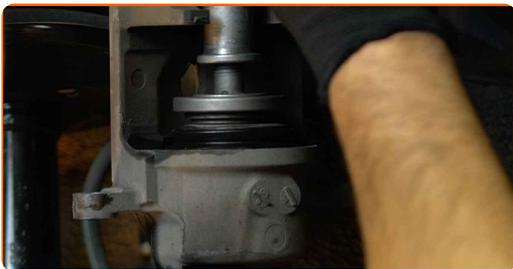
**15** Natrite brzdové platničky v mieste, kde sa ich povrch dostáva do kontaktu s držiakom brzdového strmeňa. Použite pastu proti pískaniu brzd.
