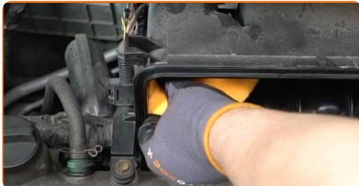
6 Odstráňte filtračný prvok z krytu vzduchového filtra.
