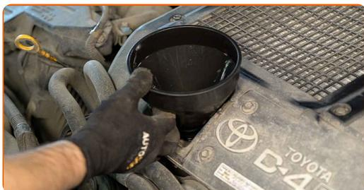
**21** Nový olej nalejte do motora, a to v množstve, ktoré odporúča výrobca auta.
