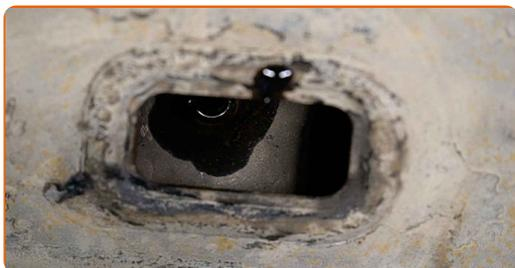
**13** Vyčistite miesto výpustného otvoru olejovej vane.
