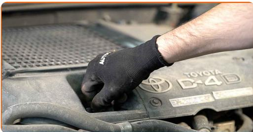
**24** Motor nechajte niekoľko minút bežať. Po tom, čo varovné svetlo tlaku oleja zmizne, vypnite motor.
