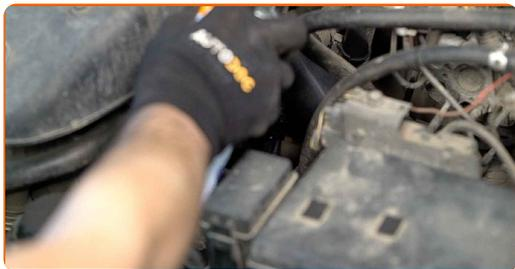
10 Odskrutkujte olejový filter. Použite nástavec 76-14F. Použite ráčňový kľúč.
