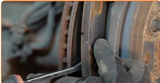
Výmena: brzdových platničiek – TOYOTA LAND CRUISER 150 (KDJ15\_, GRJ15\_). Tip od AUTODOC:
