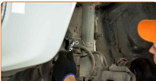
10 Vyčistite upevňovacie prvky spájajúce vzperu tlmiča a hlavu ložiska čapu kolesa. Použite drôtenú kefu. Použite sprej WD-40.
