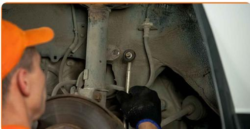
9 Odpojte vodič a brzdovú hadičku od svorky na vzpere tlmiča. Použite nástavec č.12. Použite ráčňový klíč.
