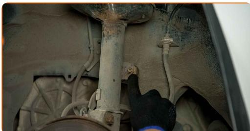
7 Odskrutkujte upevnenie spájajúce vzperu stabilizátora k vzpere tlmiča. Použite nástavec č.14. Použite ráčňový klíč.
