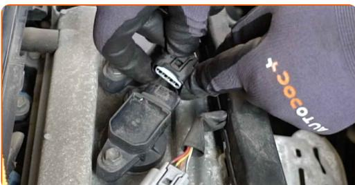
**14** Odskrutkujte upevňovacie prvky cievok zapalovania. Použite nástavec č.10. Použite ráčňový kľúč.
