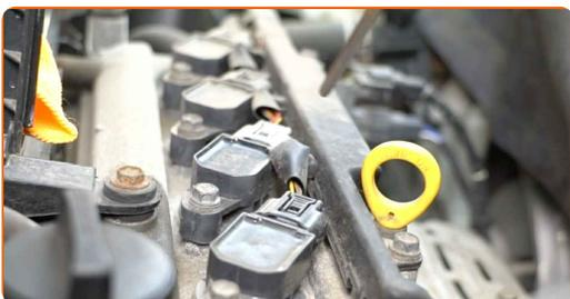
**8** Odskrutkujte upevňovacie prvky svorky káblového zväzku. Použite nástavec č.10. Použite ráčňový kľúč.
