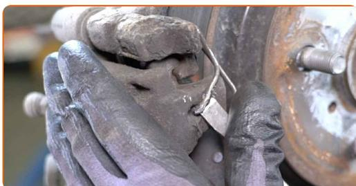
**8** Odstráňte krytky prachového puzdra vodiacich závlačiek brzdového strmeňa. Použite páčidlo.
