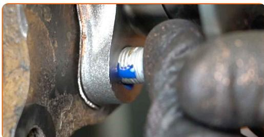
**28** Utiahnite upevňovacie prvky ložiska náboja kolesa. Použite nástavec č.14. Použite momentový kľúč. Utiahnite ju krútiacim momentom 90 Nm.
