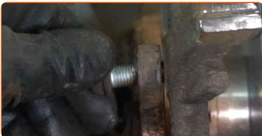
**38** Utiahnite upevňovacie prvky držiaka brzdového strmeňa. Použite nástavec č.14. Použite momentový kľúč. Utiahnite ju krútiacim momentom 57 Nm.
