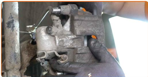
**42** Utiahnite upevňovacie prvky brzdového strmeňa. Použite imbusový kľúč č. H7. Použite momentový kľúč. Utiahnite ju krútiacim momentom 34 Nm.
