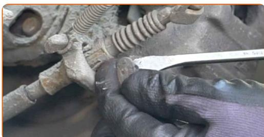
**9** Odskrutkujte upevňovacie prvky brzdového strmeňa. Použite imbusový kľúč č. H7. Použite ráčňový kľúč.
