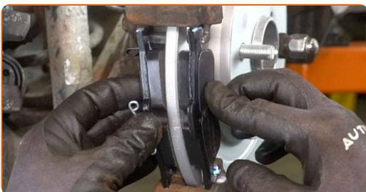
**41** Nainštalujte brzdový strmeň a upevnite ho.
