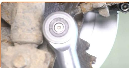
**39** Natrite brzdové platničky v mieste, kde sa ich povrch dostáva do kontaktu s držiakom brzdového strmeňa. Použite pastu proti pískaniu brzd.
